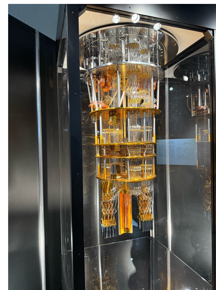
↑ 大阪・関西万博で展示された 量子コンピュータ内の希釈冷凍装置
